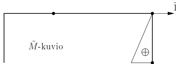
Kuva 7.14 Portaalikehän eräs virtuaalinen momenttijakauma pisteen 4 yksikkökuormasta.
