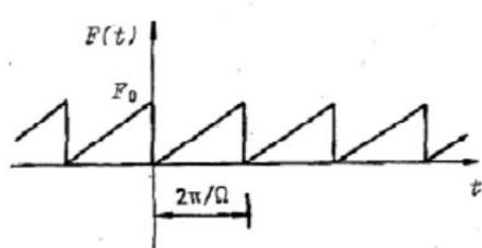
2. Esitä kuvan heräte FOURIER-sarjana ja määritä vaimentamattoman yhden vapausasteen systeemin vaste  $u(t)$ . Piirrä herätteen ja vasteen kuvaajia, jotka vastaavat FOURIER-sarjan alkupään termejä.  $\Omega = 2 \text{ rad/sec}$ ,  $\Omega/\omega = 0,80$
