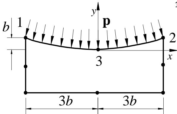
1. Kuvan kvadraattisen elementin sivulle kohdistuu hydrostaattinen painekuorma. Määritä painekuormasta aiheutuva ekvivalenttinen solmukuormitusvektori numeerisesti käyttäen kolmea integrointipistettä. Elementin paksuus on 0.01 m, mitta b on 0.1 m ja paine 10 MPa. Riittää kun lasket vain solmuille 2 ja 3 tulevat komponentit.
