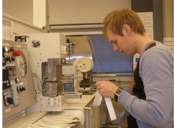
(Kuvassa: Kartongin kuumasaumauksen testausta)
